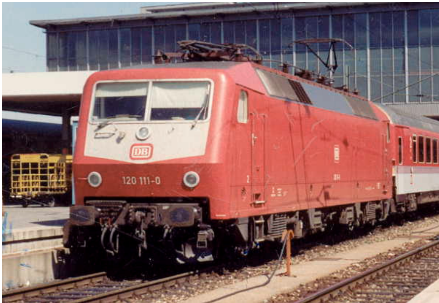
Fig 8 Ellokomotivet E120.1 (= serieversion). Lokomotivet är i praktiken "ett kombinerat TGV- och malmtågslokomotiv" (max 280 km/h). Serieversionen började att levereras under 1986. Foto: Författaren, München
