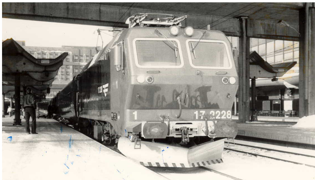
Bild 6 Det elektriska lokomotivet EI17 vid Oslo centralstation. Notera den kraftiga snöplogen och det kilformade frontpartiet, bägge lösningarna för att klara extrema vinterförhållanden. Loktypen är världens första högeffektslokomotiv med asynkronmotorer för kommersiell trafik. En stor del av den elektriska utrustningen baserar sig på det västtyska lokomotivet 120 (se bild 5). Styckepriset var 28 mkr (prisnivå 2000). Foto: författaren, Oslo februari 1988
