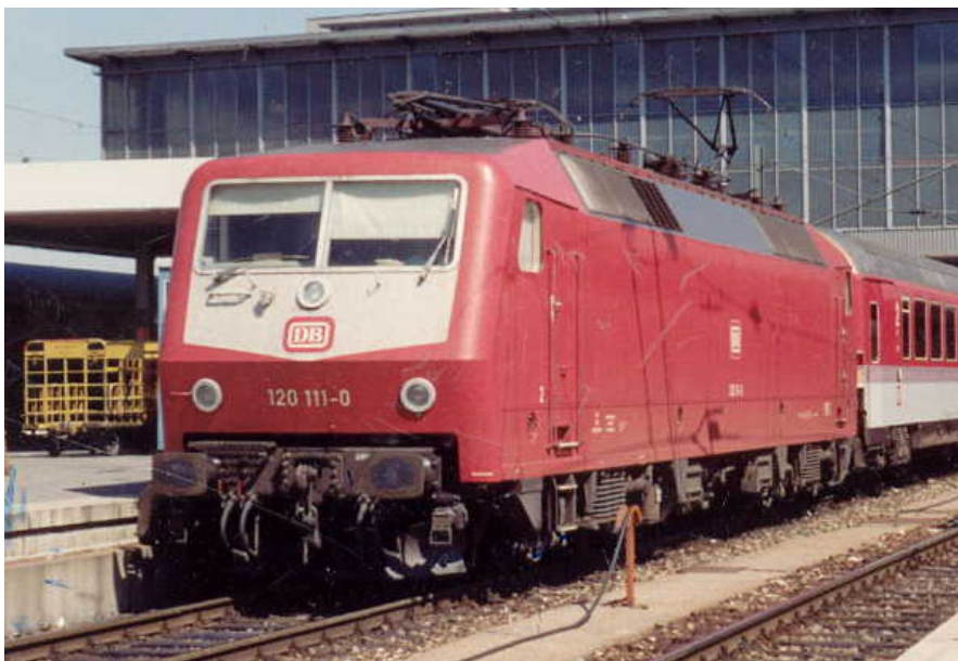
Bild 5 Det västtyska lokomotivet 120.1 i väntan på avgång vid München centralstation. Loket har en vikt på 84 ton och sth 200 km/h. Såväl det danska EA- lokomotivet som det norska E117- lokomotivet har många konstruktionslösningar från 120- lokomotivet. Styckpriset var 33 mkr (prinsnivå 2000). Foto: författaren, München augusti 1990
