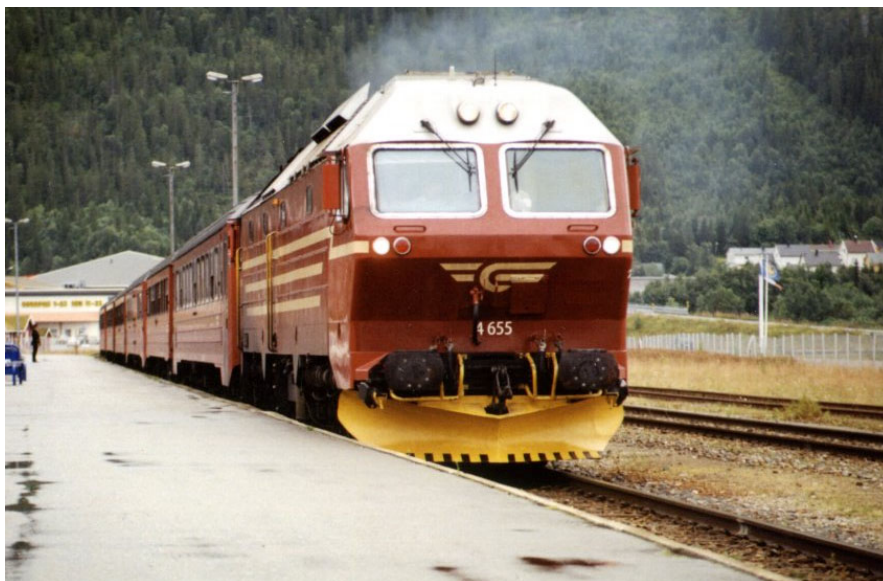
Bild 1B Det norska diesellokomotivet littera Di 4 vid stationen Mo i Rana på linjen Trondheim- Bodö (73 mil). Lokomotivet har mycket stora likheter med det danska lokomotivet ME 1500 men har mjukare infästningar av axelboxarna , tryckdragstång för boggiförankringen i längsled (istället för boggitapp) samt mjukare upphängda drivmotorer, allt för att skona bana och hjulflänsar. Loket är utrustat med den sextoncylindriga tvåtaktsdieseln 645-E3B från General Motors med effekten 2,4 MW, men är även förberett för den starkare 645-F3 (se även Tabell 3) med effekten 2,8 MW. Di4- serien beställdes under hösten 1978. Foto: www.finnmoller.dk , augusti 2000
