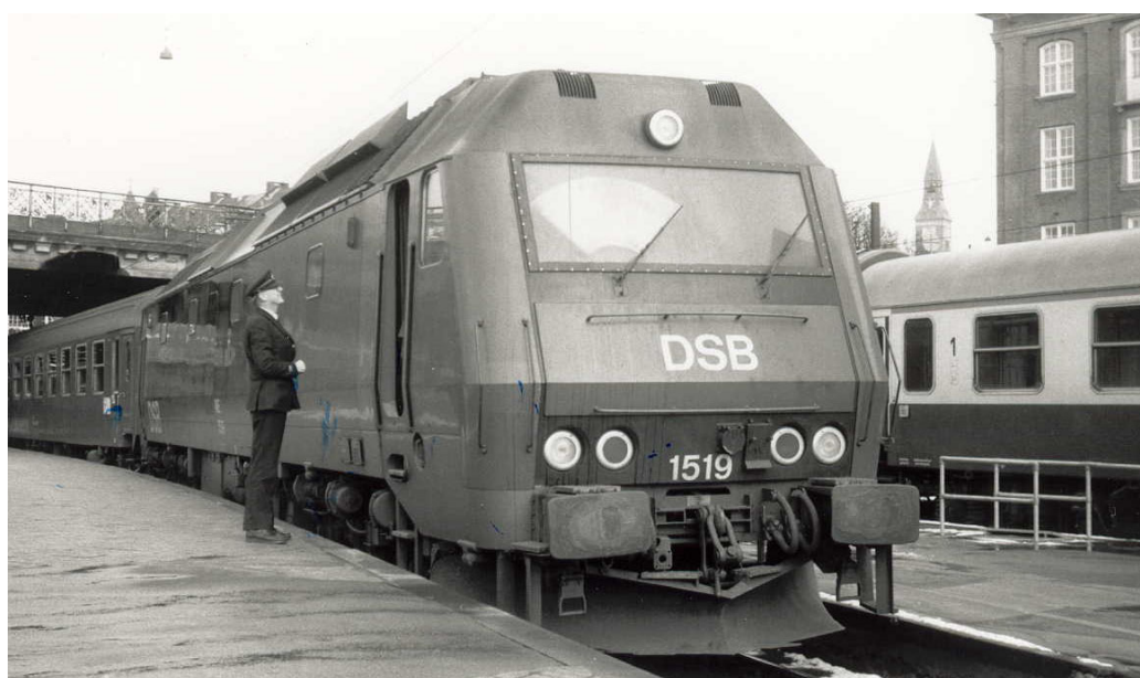
Bild 1 Ett danskt dieselelektriskt lokomotiv av typen ME vid Köpenhamns centralstation. ME- lokomotivet baserar sig till stor del på det norska Di4- lokomotivet. ME- lokomotivet har en största tillåtna hastighet (sth) av 175 km/h och drivs av en kompressormatad tvåtaktsdiesel från amerikanska General Motors. Loket beställdes under 1979 och styckpriset var för de första 7 lokomotiven cirka 21 mkr (prisnivå 2000). Foto: författaren, Köpenhamn februari 1988
