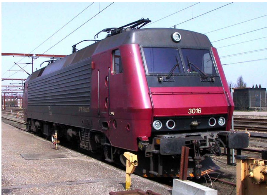
Bild 7 Det danska ellokomotivet EA vid Padborg (nära Flensburg) på södra Jylland. Denna individ har en mekanisk del som är tillverkad av danska Scandia i Randers (Jylland). Notera de långtgående likheterna i formgivningen med ME- lokomotivet (se bild 1). Lokomotivet har en vikt på 80 ton och sth 175 km/h. Styckpriset var cirka 42 mkr (2000 års prisnivå). Foto: Henrik Clausen, 2003, Danmark
