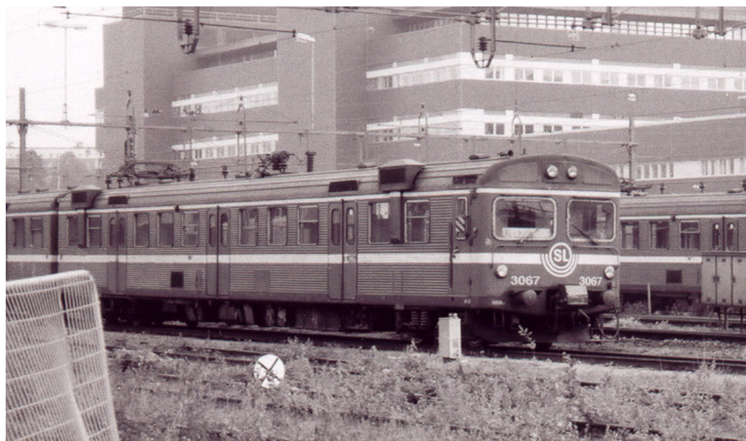
Bild 2 Det elektriska motorvagnståget X1. Tågsättet är konstruerat för lokaltågstrafik och sth 120 km/h. Ett X1- tågsätt (=2 vagnar) kostar cirka 11 mkr (prisnivå 2000), och har en tomvikt på drygt 77 ton. Foto: författaren, Sundbyberg rangerbangård, september 2003
