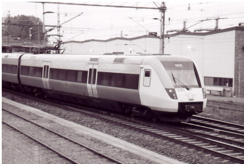
Bild 4 Det eldrivna motorvagnståget "Regina". Tågsättet har en modern formgivning men varje vagn har en tjänstevikt kring 60 ton, vilket till och med 2001 var ett SJ- rekord vad gäller specifik vikt (2,23 ton per meter, senare har motorvagnståget X40 tagit över den föga avundsvärda titeln). Vagnen väger mer än en tyngre stridsvagn! Foto: författaren, Linköping, oktober 2003
