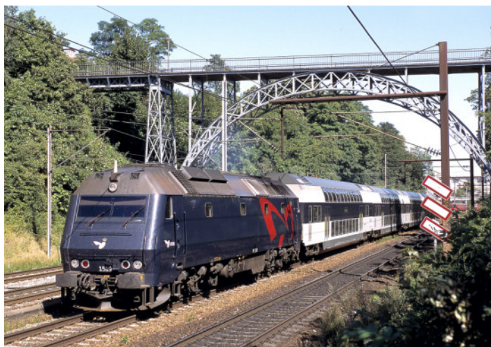
Bild 6 Ett danskt regionaltåg med ett dieselelektriskt lokomotiv av typen ME. DSB använder sedan flera decennier loktåg i sina regionaltrafik. Foto: foto: René Strandbygaard/ DSB
