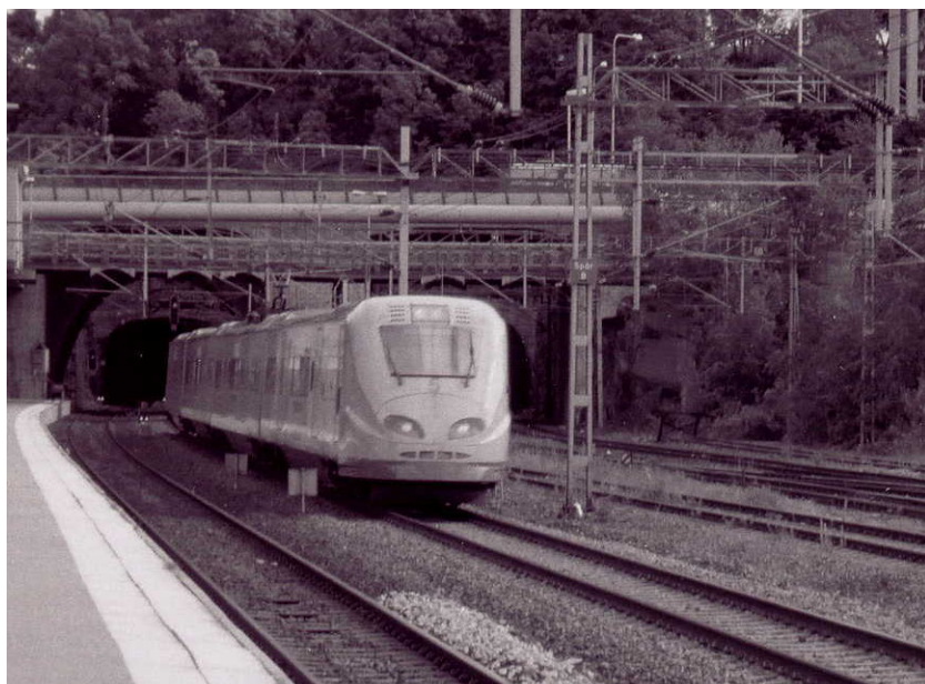
Bild 5 Motorvagnståget X3 på väg ut ur Solna- tunneln på väg mot Arlanda flygplats. Till skillnad mot andra svenska motorvagnståg har X3 handikappvänliga insteg då plattform och vagnkorg ligger i samma nivå (likt passagerarflygplan samt tunnelbanevagnar). Foto: författaren, Solna lokaltågstation, juni 2003
