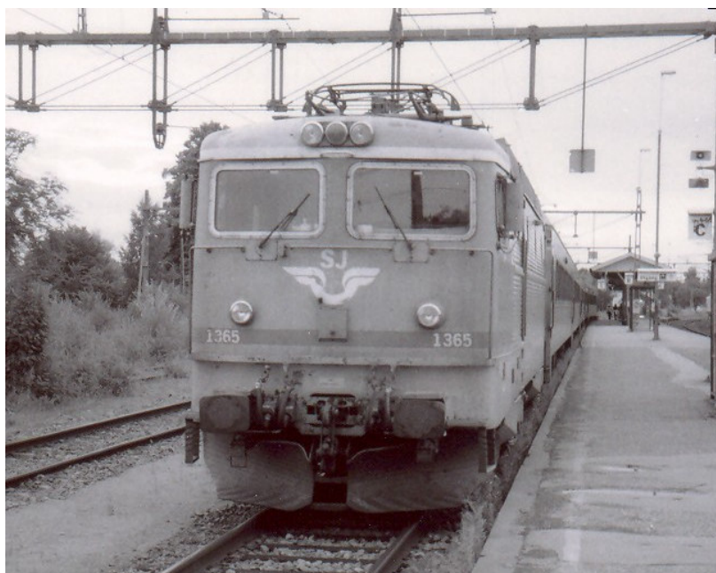
Bild 1 Ett elektriskt allround- lokomotiv av typen Rc vid Nyköpings centralstation. Artikeln visar att konventionella loktåg även är lämpliga för lokaltågstrafik. De främsta fördelarna med loktåg är betydligt lägre investeringskostnader samt ökad kollisionssäkerhet. Lokomotivet väger cirka 78 ton men kan barlastas till 90 ton, vilket ökar den maximala dragkraften. Ett barlastat lokomotiv lämpar sig även för lokaltågstrafik. Foto: Författaren, Nyköping, juli 2005
