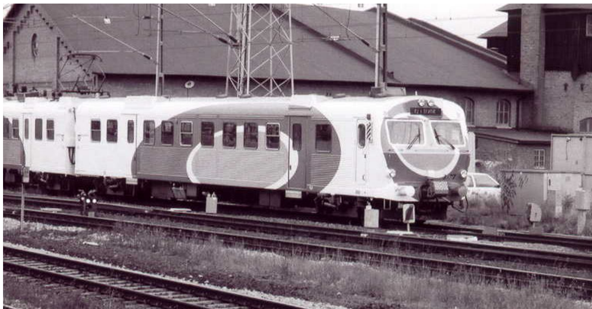
Bild 3 Det elektriska motorvagnståget X14 med en något annorlunda färgsättning. Motorvagnstypen baserar sig på motorvagnståget X10, som började att rulla i Skåne under slutet av 70-talet och senare har satts i trafik även i Stockholms- och Göteborgsregionen. Ett X10- tågsätt (=2 vagnar) kostar cirka 25 mkr (prisnivå 2000). Jämfört med sin föregångare (X1) har X10 cirka 38 % högre tomvikt per sittplats och en investeringskostnad som är hela 138 % högre per sittplats. Foto: författaren, Linköping oktober 2003
