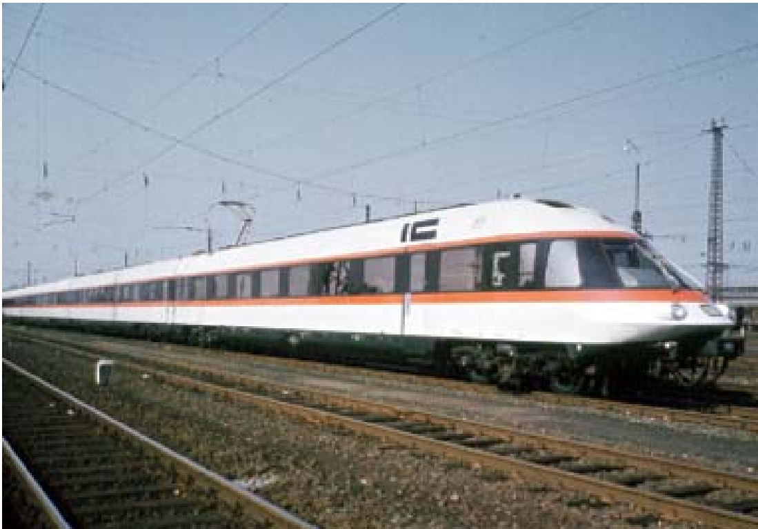
Bild 2B Det västtyska motorvagnståget ET 403. Tågsättet har 4 vagnar, tomvikten 236 ton och sth 200 km/h. Normalt har ett fjärrtåg en specifik effekt kring 400 kW/vagn men ET 403:an har inte mindre än 1.500 kW/vagn. Foto: DB AG (med vederbörligt tillstånd)
