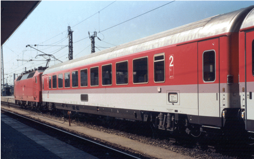
Bild 1. En västtysk IC- vagn av typen Bpmz 291, ombyggd till trycktrögt utförande. IC- vagnen är godkänd för 200 km/h men har provkörts i 335 km/h. Längst fram ser vi allround- lokomotivet 120, som i prototypversionen utfördes för sth 280 km/h. Lägga märke till vagnens släta utsida och inklädda underrede. Fordonen klarar i praktiken konstruerade för 250 km/h och har provkörts i Norrbotten. Foto: Författaren, München centralstation, augusti 1990
