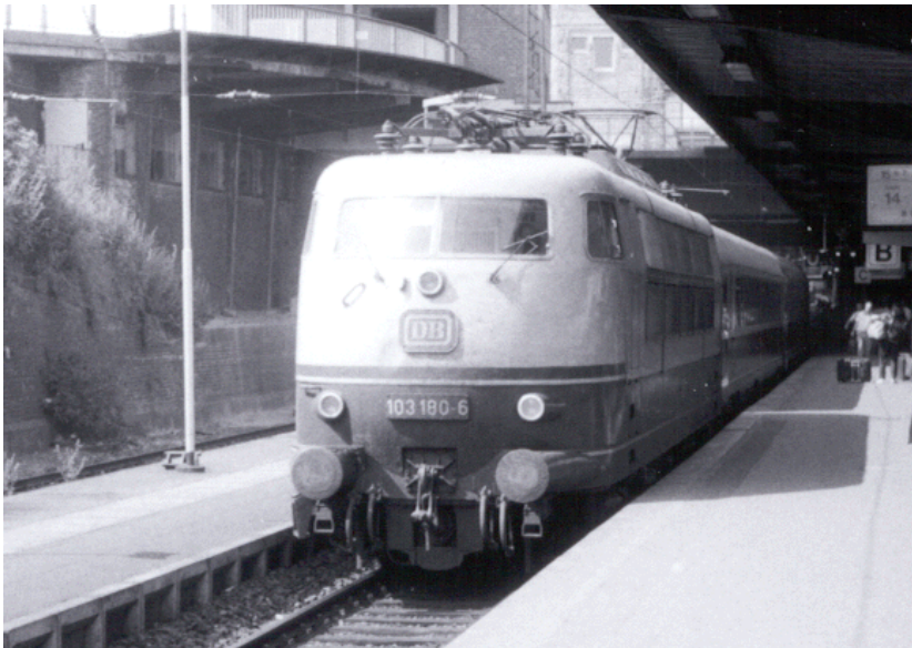
Bild 4 Ett IC- tåg vid Hamburg centralstation med destination München. IC- tåget dras av lokomotivet 103.1 med toppeffekten 9.000 kW. Lokomotivet har dock under en provkörning juni 1985 uppnått hastigheten 283 km/h. Vid motorbromsning (reostatisk) utvecklade de sex drivmotorerna inte mindre än 9.600 kW, det vill säga mer än den maximala dragkratseffekten. Dock fick denna reostatiska motorbromsning ej äga rum under mer än 21 sekunder på grund av risken för överhettning. Foto: Författaren, Hamburg centralstation, juli 1987
